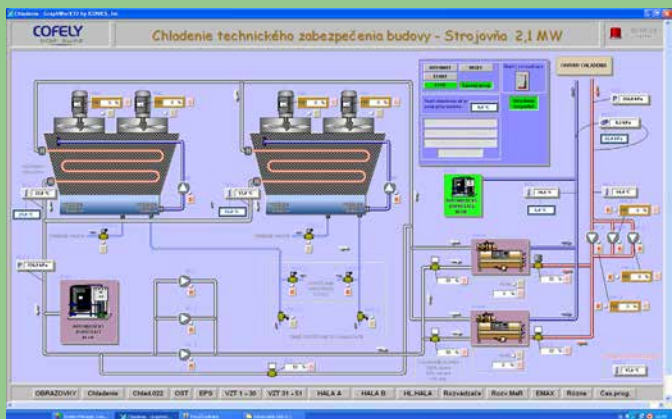
Ondrej Nepela Ice Rink Monitoring Display
